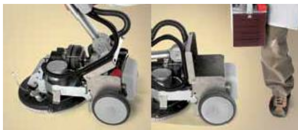
Vispa 35 B Batteriholderen er let tilgængelig og det er dermed hurtigt at udskifte batteriet.
